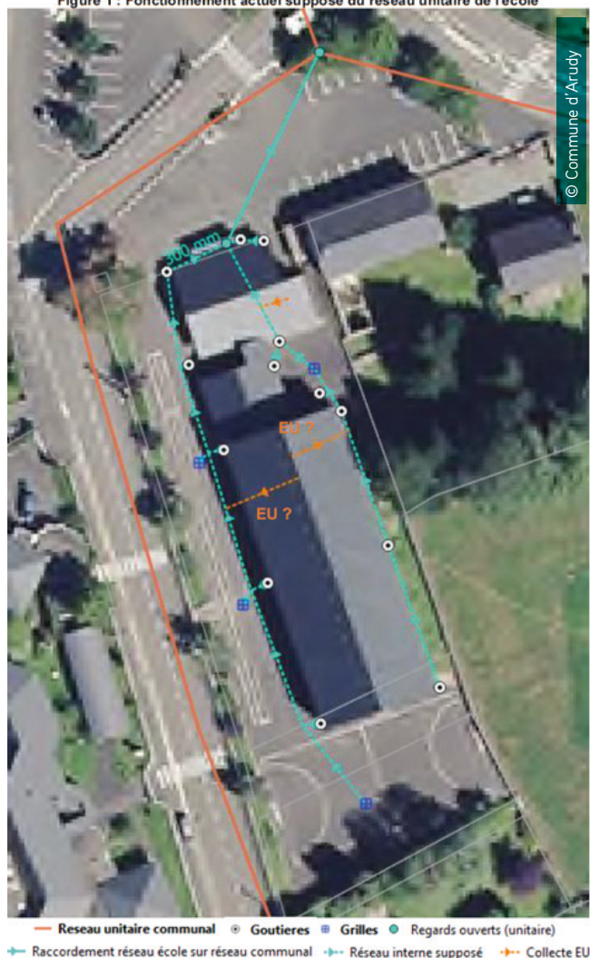
Figure 1 : Fonctionnement actuel supposé du réseau unitaire de l'école
